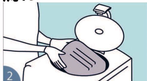
2 汚物入りの容器をそのまま処理装置に入れて運転開始
